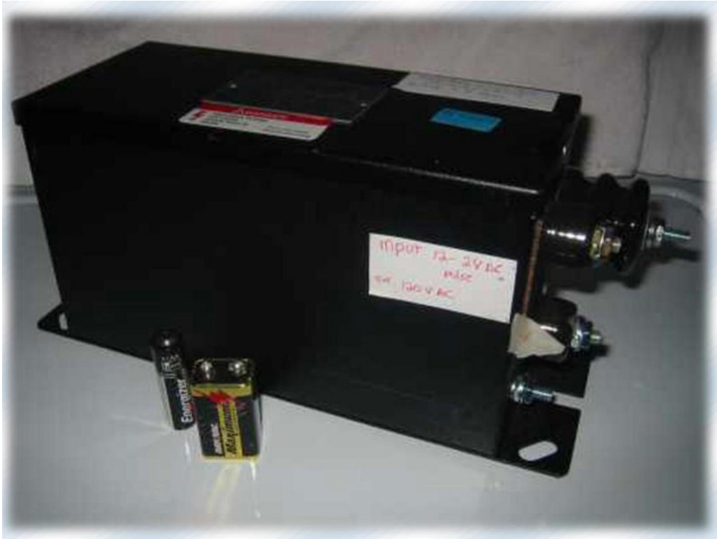
15,000 volt Neon sign transformer
